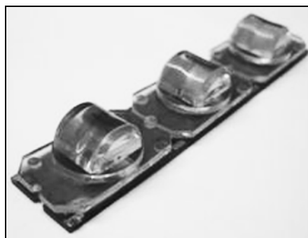
Рис. 6. Элемент конструкции полупроводникового аналога электролюминесцентной лампы
