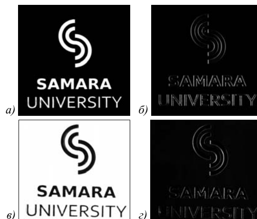
Рис. 4. Выделение контуров для амплитудного образца с линейными размерами 2,5×2,5 мм: оригинальные изображения (а),(в); соответствующие преобразованные изображения (б),(г)
