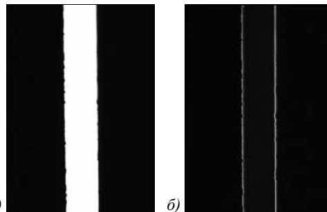
Рис. 2. Оптическое дифференцирование кусочно-гладкого распределения интенсивности: изображение интенсивности пучка, проходящего через щелевую апертуру с контролируемой шириной (200 мкм) (а), и распределение интенсивности отражённого пучка (б)
