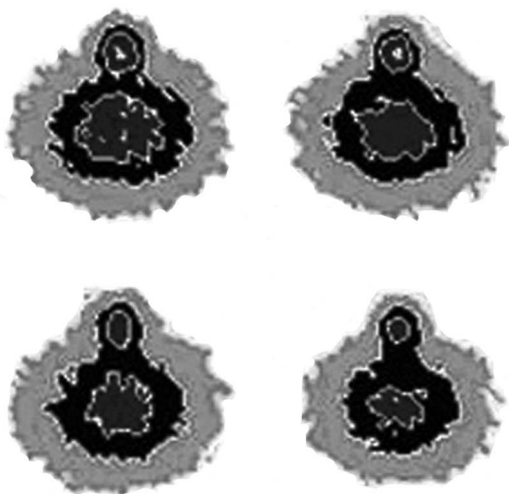
Рис. 9. Карта уровней интенсивности на фотоприемнике в отсутствии неоднородности (а) и для неоднородности диаметром 1,4 мм (б); 2 мм (в); 2,8 мм (г)
