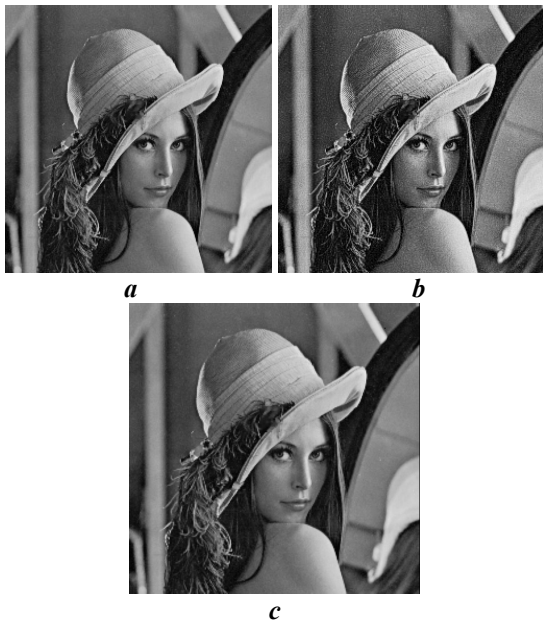
Рис. 10 Экстраполяция спектра на MVN: (а) оригинал 256x256; (б) изображение 512x512, полученное из экстраполированного спектра оригинала; (с) изображение 512x512, полученное билинейной интерполяцией.
