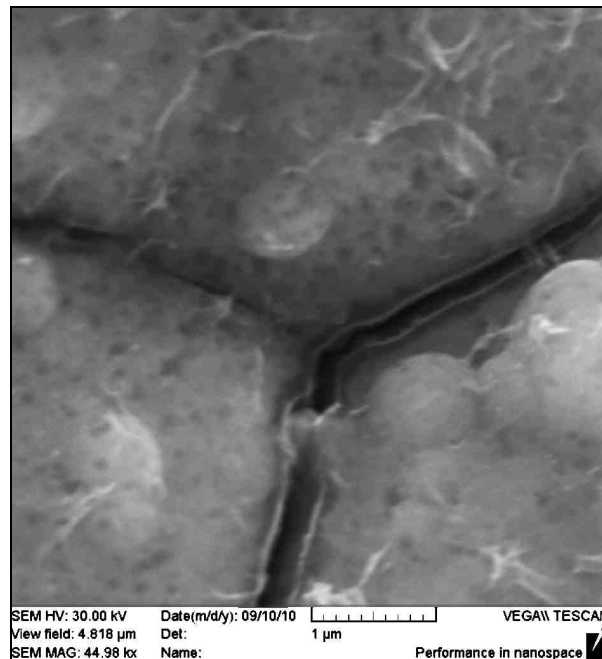
Рис. 2. Нанопоры канального типа шириной ~100 нм, формирующиеся на границе субзерен в латуни Л62 при лазерном воздействии в вакууме; увеличение \times 44980
